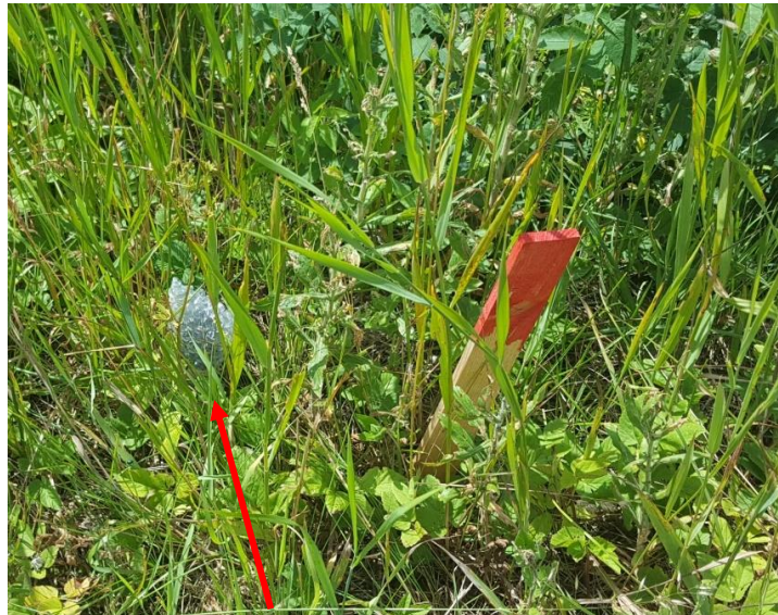
En lufttrycksloggare i skyddande bubbelplastpåse.
